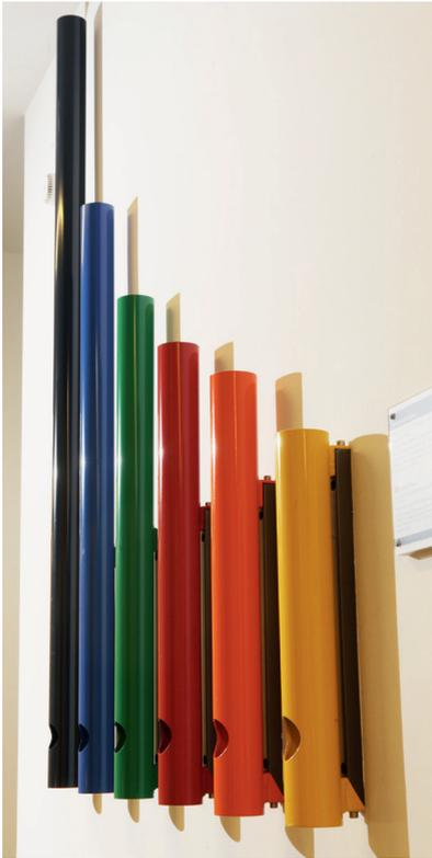
Jede der Röhren hat vorne ein Loch, an das man sein Ohr halten kann. Pro Röhre hört man einen Ton, und zwar immer den gleichen. Die Röhre filtert aus dem Umgebungslärm den Ton heraus, der zu ihrer Länge passt.
