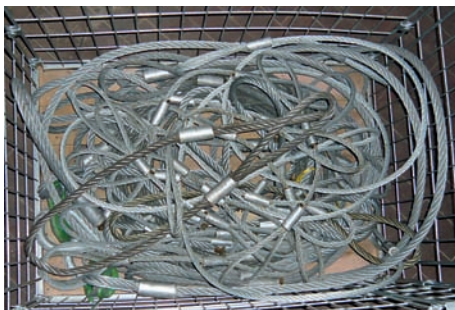
Bild 7: Unsachgemäße Lagerung von Anschlagseilen
