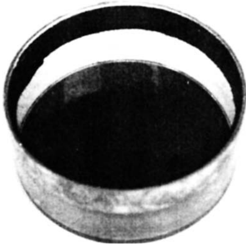
Abb. 7d: Kleben Sie den Samtstreifen an den oberen Rand der Schüssel und tränken Sie ihn mit Brennspritus.
