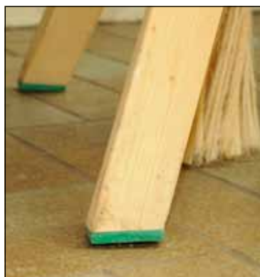
Kunststoffplatten schützen das Holz vor Feuchtigkeit.
