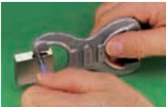
Fig. 4 : Contrôle d'un calibre mâchoires avec des cales étalons et une jauge cylindrique
