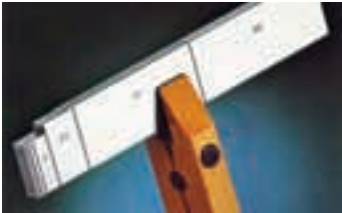
Fig. 3 : Combinaison de cales étalon
