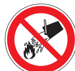
Mit Wasser löschen verboten
