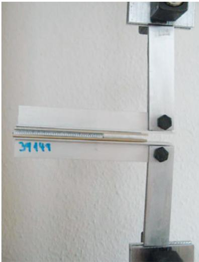
**BILD 5.16** Keiltest von Klettverbindungen mit Aluminium-T-Profilen
