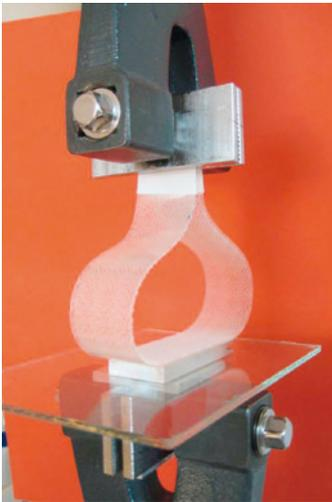
**BILD 5.2** Prüfanzordnung des Schlaufentestes mit Druckverschlussband
