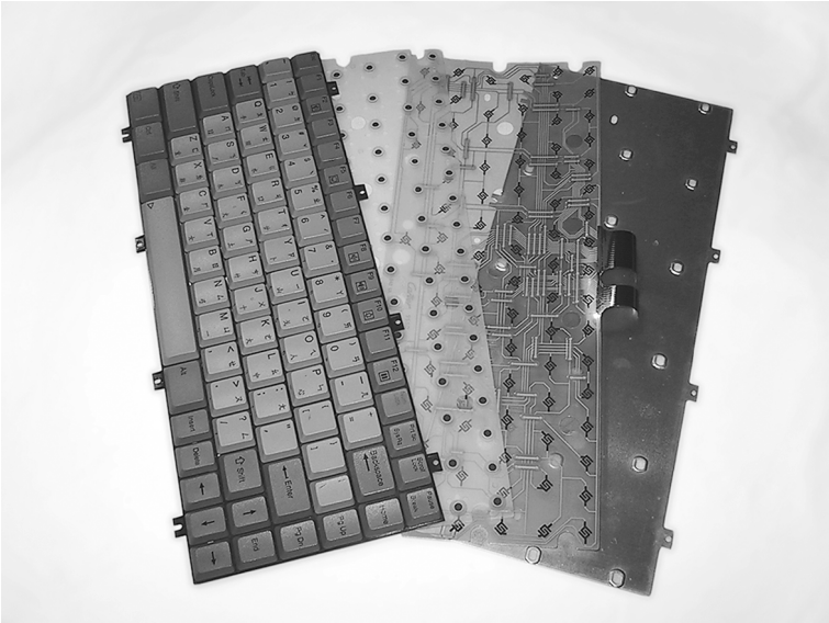
Abb. 1 Tastenkappen, Silikonschaltmatte mit Karbonpillen, Leiterplatte und Stützplatte: Aufbau einer Computertastatur
