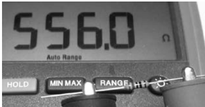
Abb. 3–4 Multimeter beim Messen eines 560-Ω-Widerstands mit 1 % Toleranz
