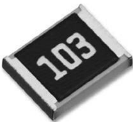
Abb. 3–3 Beispiel für einen Widerstand zur Oberflächenmontage
