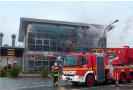
**Abb. 4.3.2/1:** Relativ wenig Rauch verlässt das Gebäude, da der Brandrauch sich im gesamten Gebäude verteilen konnte. Trotzdem lag im Innern ein fortentwickelter Brand vor. (Foto: Feuerwehr Osnabrück)
