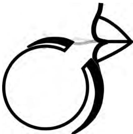
Die Querflöte funktioniert genau wie die Kerbflöte. Die scharfe Schneide, gegen die der feine Luftstrahl treffen muss, ist hier die eine Seite des Tonloches. Auf dem linken Bild siehst du die Querflöte, die hier quer zum Rohr „aufgeschnitten“ ist.
