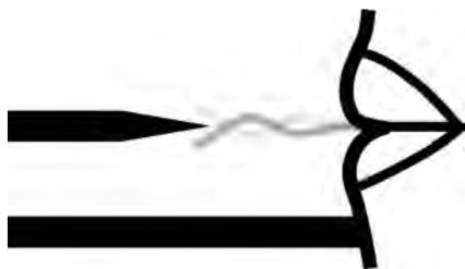
Stellen wir uns nun vor, dass der Teil mit dem Block und dem Luftkanal abgesägt wäre. Solch eine Flöte heißt **Kerbflöte** (rechts). Hier müssen wir den Luftkanal mit unseren Lippen bilden:
