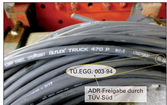
Bild 2: Leitung mit ADR-Freigabe
