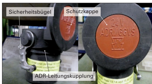
Bild 3: ADR-Leitungskupplung nach IP 54
