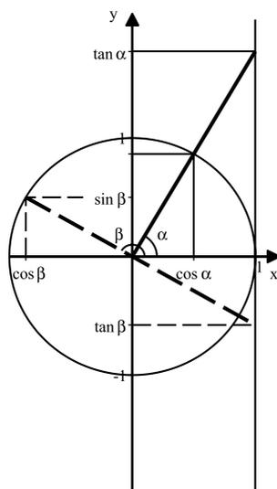
**Abbildung 1.14** Die Definition der trigonometrischen Funktionen durch einen Kreis mit Radius 1. Der Winkel  $\alpha$  liegt im 1. Quadranten, deshalb sind sein Sinus, sein Cosinus und sein Tangens sämtlich positiv. Der Winkel  $\beta$  liegt im 2. Quadranten. Deshalb ist sein Sinus positiv, während sein Cosinus und sein Tangens negativ sind.
