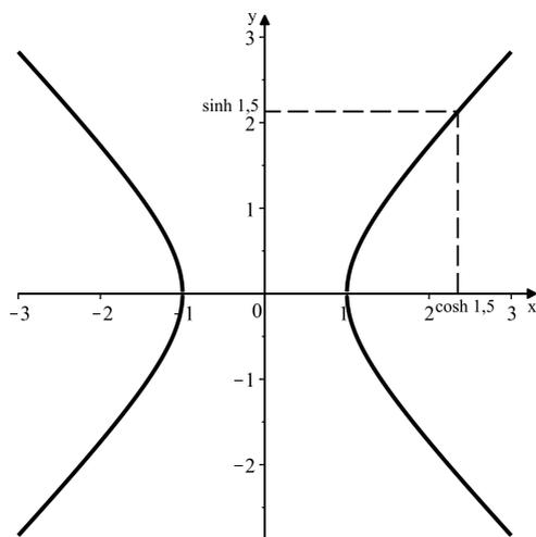
**Abbildung 1.12** Wenn Sie für eine reelle Zahl  $t$  auf der positiven  $X$ -Achse den Wert  $\cosh t$  abtragen, dann hat die  $y$ -Koordinate des entsprechenden Hyperbelpunktes den Wert  $\sinh t$ . Für  $t > 0$  gehen Sie dabei nach oben, für  $t < 0$  gehen Sie nach unten.
