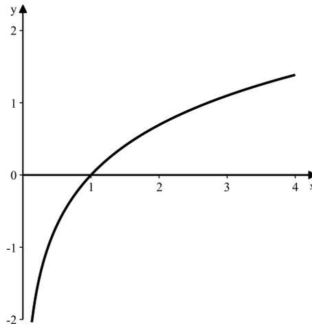
**Abbildung 1.9** Die Funktion  $f^{-1}(x) = \ln x$  ist die Umkehrung der Funktion  $f(x) = e^x$ . Sie ist nur für positive Werte von  $x$  definiert, streng monoton steigend und nach unten und oben unbeschränkt.
