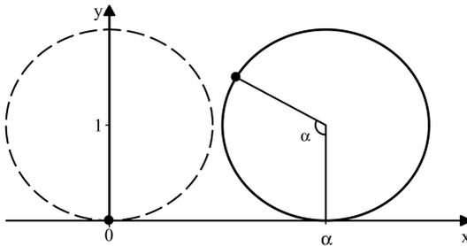
**Abbildung 1.19** Wenn ein Kreis mit dem Radius 1 auf einer waagerechten Unterlage rollt und sich dabei um den Winkel  $\alpha$  dreht, dann hat der Weg, den er auf der Unterlage zurücklegt, ebenfalls die Länge  $\alpha$  – jedenfalls, wenn man im Bogenmaß rechnet!
