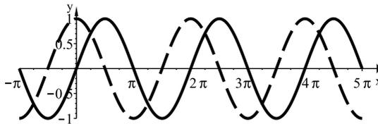
**Abbildung 1.15** Die Kurven der Sinusfunktion (durchgezogen) und der Cosinusfunktion (gestrichelt) im X-Y-Koordinatensystem. Die Kurven haben identische Gestalt, die Cosinuskurve ist gegenüber der Sinuskurve um  $\frac{\pi}{2}$  nach links verschoben. Die Funktionen sind periodisch mit der Periodenlänge  $2\pi$ .
