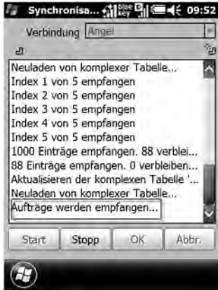
Abb. 4.1.1/5: Synchronisation des mobilen Endgeräts zum Auftragsempfang
