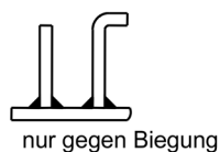
Bild 3.72 Versteifungen flächiger Teile durch aufgeschweißte Profile
