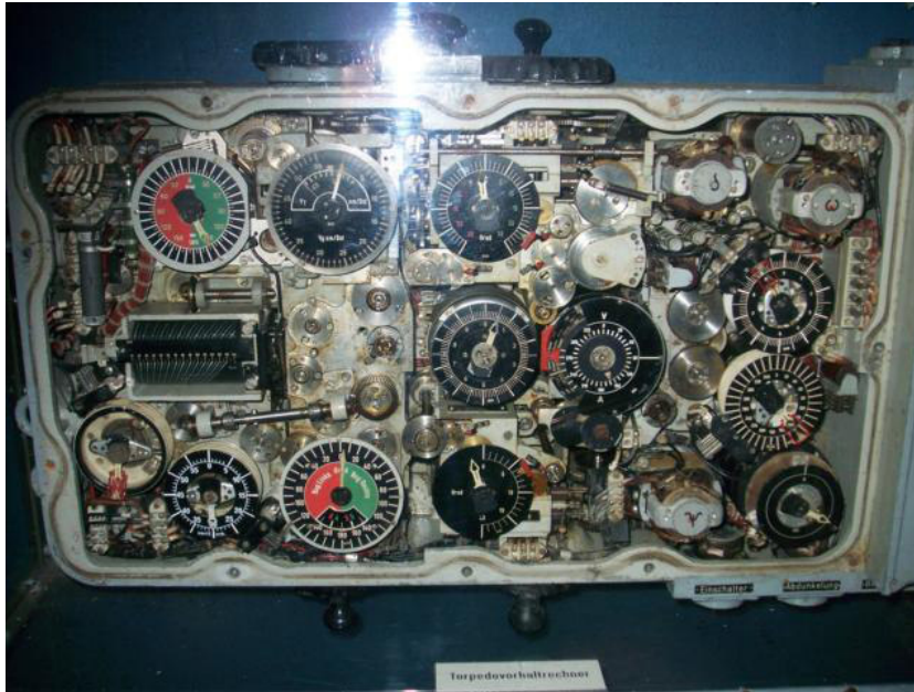
Abbildung 1.1: Der Torpedovorhaltrechner von U 995 in Laboe (geöffnet)
