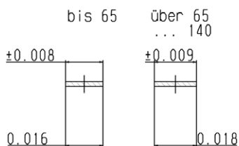
Bild 2.7: Kolbenform, Maß- und Formtoleranzen
