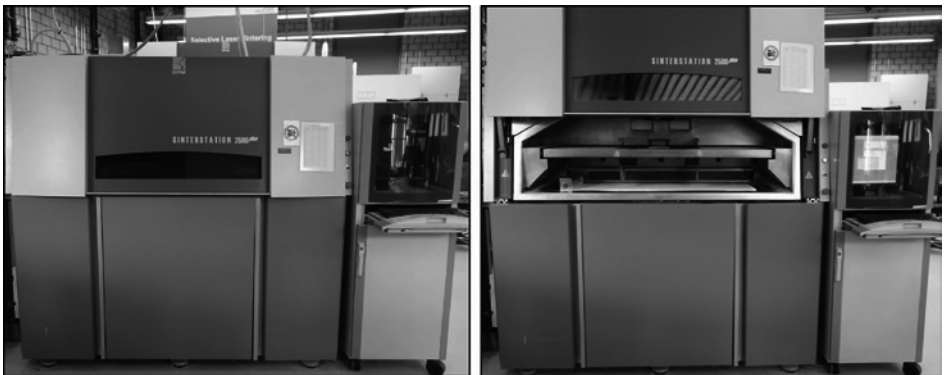
Bild 2.2 DTM SinterStation 2500plus (Baujahr 1999); links: geschlossen; rechts: offen, mit Blick in den Baubereich (Prozesskammer) [Quelle: Inspire AG]
