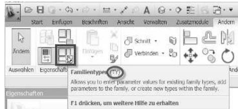
Wenn Sie nun bei den Parametern verschiedene Werte eintragen und auf ANWENDEN klicken, muss sich die Geometrie flexibel verändern, deshalb nennt man diesen Vorgang in Revit „flexen“.
