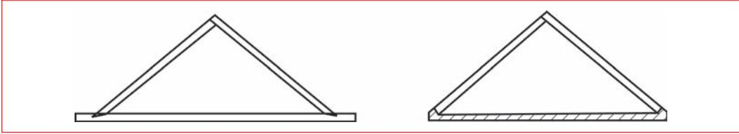
**Bild 2.5.61** Prinzip des Sparrendaches: a) in Verbindung mit einer Holzbalkendecke
