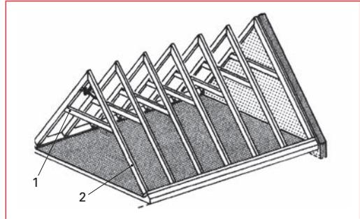
**Bild 2.5.63** Sparrendach mit Kehlbalken
