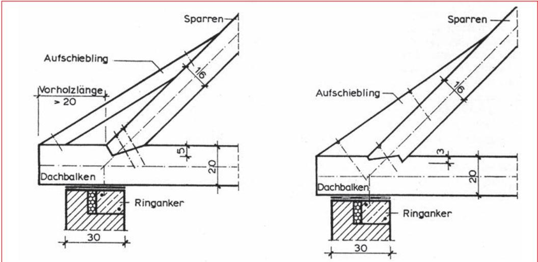
**Bild 2.5.65** Fußpunktausbildung eines Sparrendaches (Holzkonstruktion):
