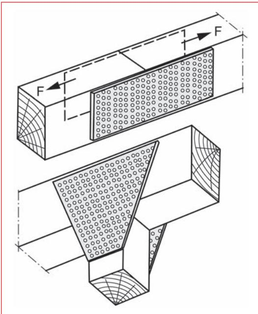
**Bild 2.5.44**Lochplattenverbindung für eine zugfeste
