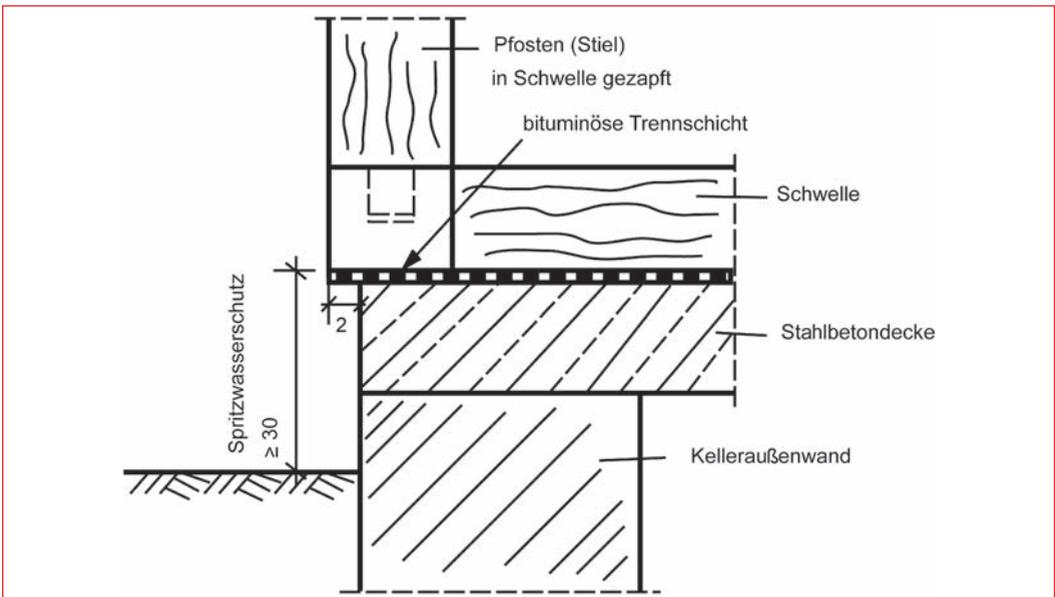
**Bild 2.5.59** Auflagerung der Schwelle auf der Decke
