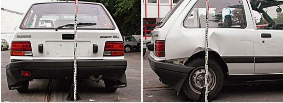
Abb. 32: Vergleichsheckschaden des Suzuki Swift.
