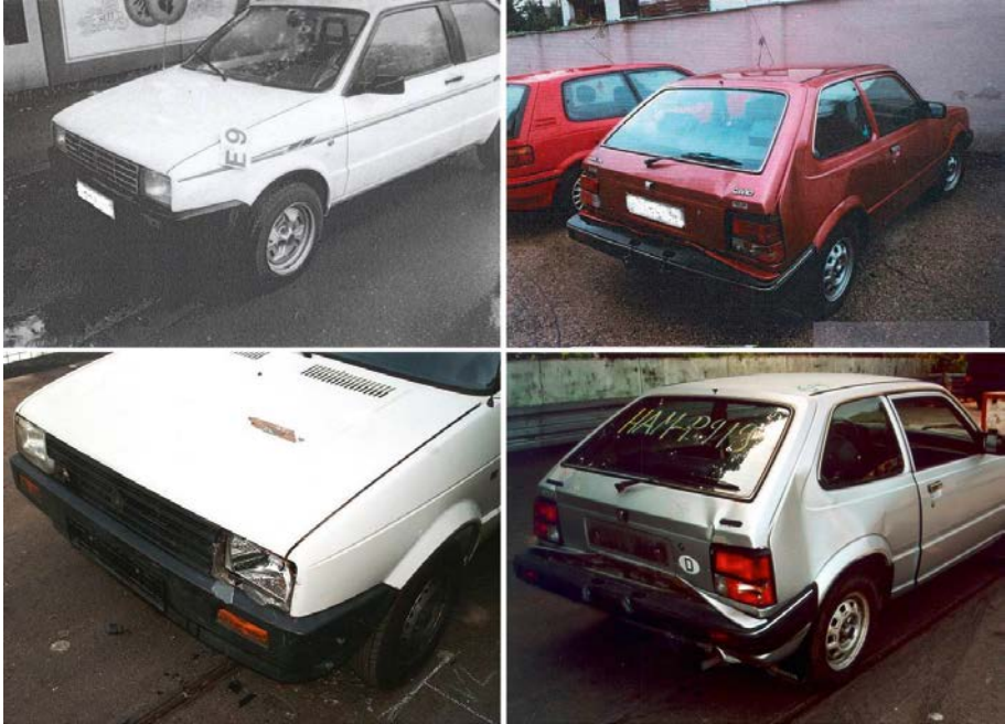
Abb. 34: Visueller Vergleich der Schäden von Unfall (oben) und Crashtest (unten).
