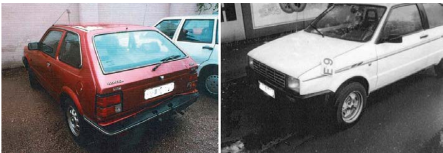
Abb. 30: Unfallschäden einer Auffahrkollision zwischen einem Seat Ibiza und einem Honda Civic.
