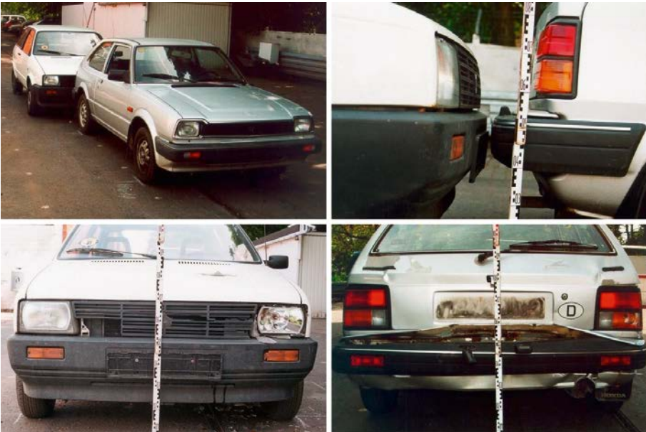
Abb. 33: Anstoßkonfiguration und Vergleichsschäden des Kollisionsversuchs.
