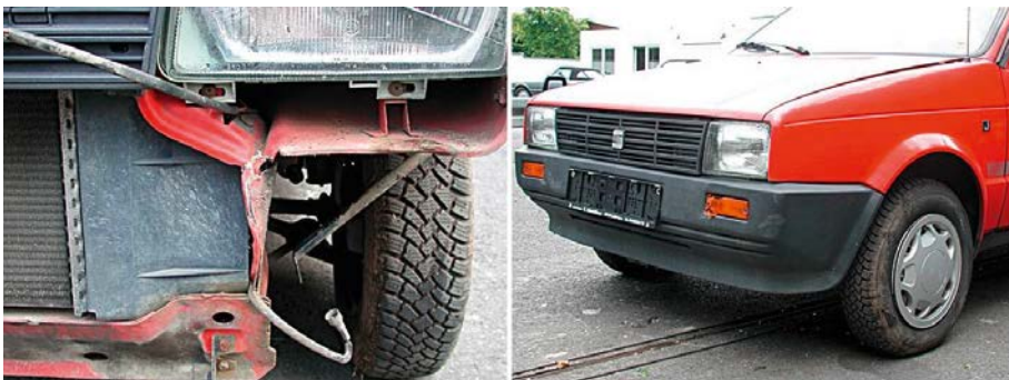
Abb. 31: Vergleichsfrontschaden des Seat Ibiza.
