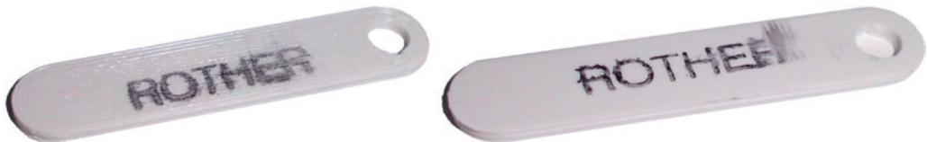
**Bild 7.28** Wischergebnis der bedruckten Schlüsselanhänger (links: wellige Oberfläche, rechts: glatte Oberfläche)
