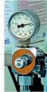
Abb. 1.9 Sog überprüfen und ggf. reduzieren.
