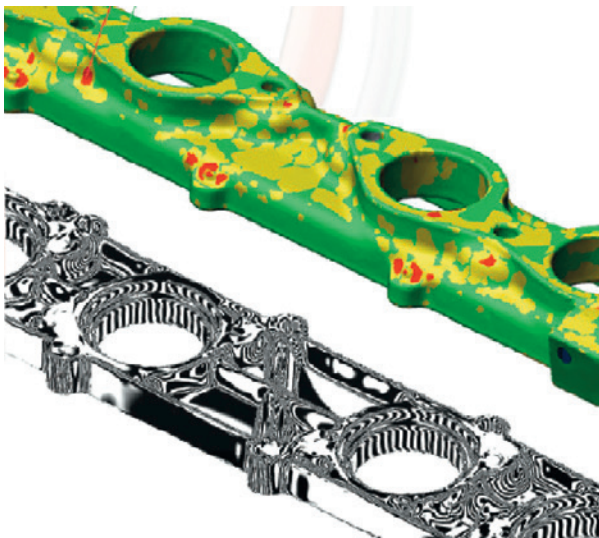
Bild 2.32 Falschfarbendarstellung erleichtert die Beurteilung der NURBS-Flächen (oben), unten: Das Zebra-Muster zeigt Stetigkeitsbedingungen an, ein gleichmäßiges Muster bedeutet Krümmungstetigkeit der NURBS-Flächen (mit freundlicher Genehmigung von Duwe-3D AG).
