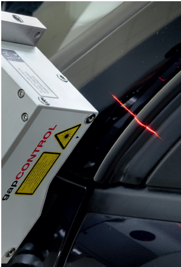
Bild 2.26 Optische Sensoren prüfen die Autokarosserie nach dem Verbauprozess (mit freundlicher Genehmigung von Mikro-Epsilon Messtechnik GmbH)
