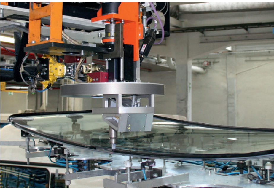
Bild 2.25 Laserscanner überprüfen die Höhe der Kleberaube am Scheibenrand (mit freundlicher Genehmigung von Mikro-Epsilon Messtechnik GmbH)
