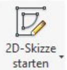
Mit der Schaltfläche **2D-SKIZZE STARTEN** öffnen wir die Skizzenansicht. Inventor blendet an dieser Stelle zunächst die drei Ursprungsebenen (XY, X-Z und Y-Z) ein und verlangt die Auswahl der Ebene, auf der eine neue Skizze erstellt werden soll. Für die erste Skizze dieses Bauteils ist die **X-Y-Ursprungsebene** auszuwählen. Wenn hierfür die Maus über die dargestellten Ebenen gezogen wird, erscheint jeweils ihr Name.
