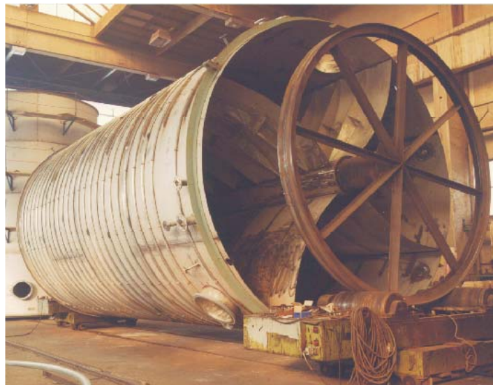
Abb. 6-18: Vierkammertank mit einem Gesamtvolumen von 200 m 3 in der Fertigung. Werkstoff C-Stahl, beheizbar durch außenliegende Rohrschlangen (Werksfoto Gronemeyer & Banck, Steinhagen)
