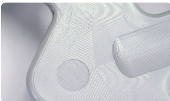
Bild: Kunststoffteile werden nach dem Spritzgießen mit Auswerfern aus der Spritzgießform geworfen. Die Auswerfer sollten nicht auf sichtbare Flächen ansetzen, da diese dort kreisrunde Abdruckstellen hinterlassen./ Hersteller: Froli
