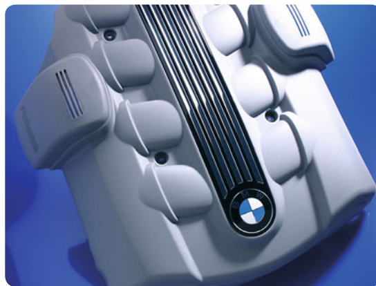
Bild: Mit ihrer zunehmenden Leistungsfähigkeit halten Kunststoffe immer stärker Einzug in Bereiche mit sehr hoher Temperaturbelastung, wo sie Anwendungen aus Metall ersetzen. Im Automobil-Motorraum treten Betriebstemperaturen von 180...200°C auf, wofür der Kunststoff Ultramid® A3WG10 entwickelt wurde, einen Compound der auf PA66 mit 50% Glasfasern basiert./ Foto: BASF SE
