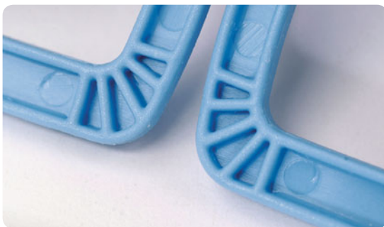
Bild: Versteifungsrippen auf der Bauteilunterseite vermeiden Materialanhäufungen./ Hersteller: Froli
