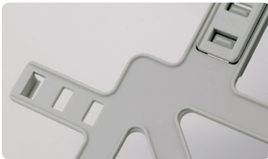
Bild: Mit einfachen Spritzgießwerkzeugen können Schnapphaken zur Verbindung von Bauteilen gefertigt werden. Der Hinterschnitt im Schnapphaken wird durch eine Öffnung ermöglicht, durch die das Werkzeug (»Schieber«) den Haken formen kann./ Beispielteile: Froli
