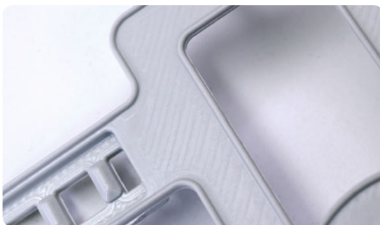
Bild: Sichtflächen auf Kunststoffteilen sind meist mit einer Struktur versehen. Auf den nicht sichtbaren Oberflächen können Frässpuren sichtbar bleiben, um die Kosten des Formbaus gering zu halten.
