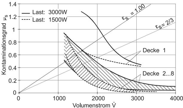
Bild F2-45 Gemessene Kontaminationsgrade unter OP-Decken (Beispiele). Der Kontaminationsgrad  $\mu_s$  stellt einen lokalen Stoffbelastungsgrad dar [F-49]
