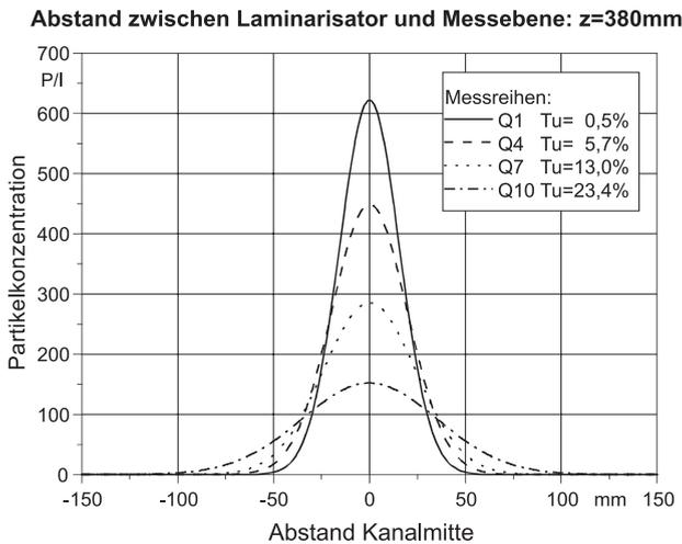
**Bild F2-33** Partikelverteilungen einer Verdrängungsströmung mit unterschiedlichen Turbulenzgraden nach Scheer [F-36]
