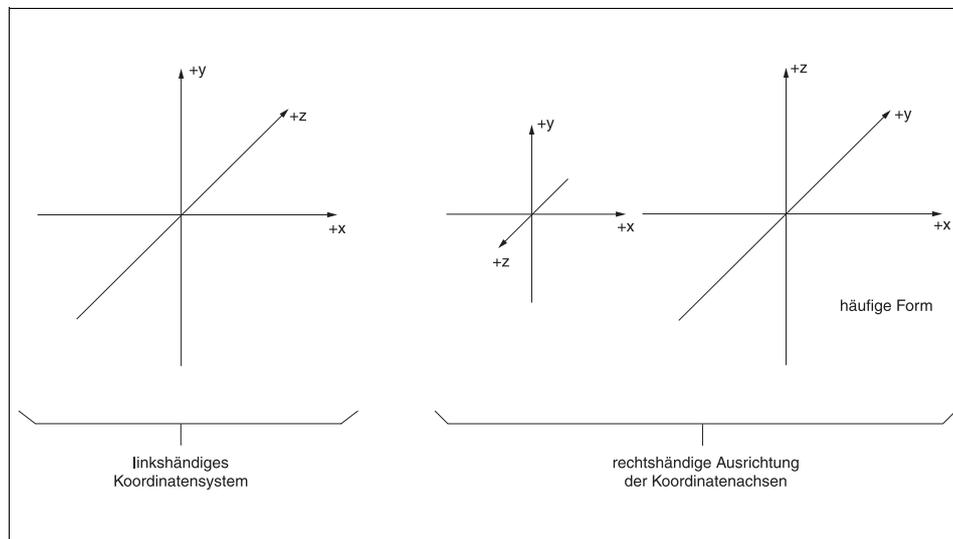
**Abb. 1.4:** Der Unterschied zwischen links- und rechtshändigen Koordinatensystemen
