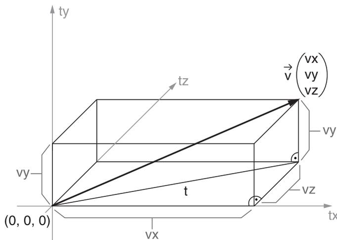
Abb. 1.8: Grafischer Ansatz zur Berechnung der Länge eines beliebigen Vektors
