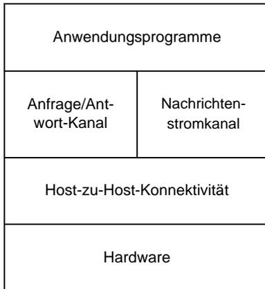
Abb. 1.9: Mehrschichtiges System mit alternativen Abstraktionen auf einer bestimmten Schicht
