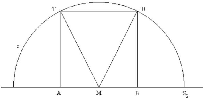
**Abb. 1.7:** Weitere Konstruktion des Goldenen Schnitts:  $c$  ist der Kreisbogen  $(M, MT)$ .  $ABUT$  ist ein Quadrat.  $AM = MB$ , der Punkt  $S_2$  ist der Schnittpunkt von  $c$  mit der Strecke durch  $A$  und  $B$ .
