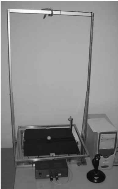
Abb. 1.2. Wippe: Balancieren einer Kugel auf einer Fläche. Im Mittelpunkt des Versuchsaufbaus steht die Kugel, die auf der Fläche gehalten werden soll. Dazu ist die Fläche beweglich in einem Rahmen aufgehängt und kann gezielt um zwei Achsen gedreht werden. Am oberen Ende des Rahmens erfasst eine Digitalkamera Fläche und Kugel. Ziel ist es, eine bewegte Kugel, die beispielsweise auf diese Fläche geworfen wird, aufzufangen, deren Bewegung zu verlangsamen und sie in der Mitte der Fläche zum Stehen zu bringen.
