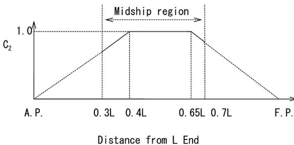
Fig. 2.2.2 Coefficient  $C_2$ : distribution factor
