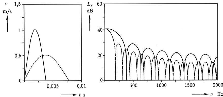
**Abb. 12.3.** Vergleich von zwei Impulsen gleicher Impulsfläche im Zeit- und Frequenzbereich
