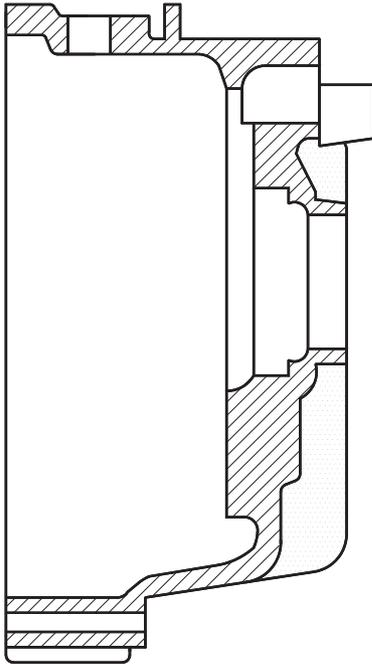
**Abb. 12.4.** Anordnung einer Vorschaltmasse in einem Getriebegehäuse
