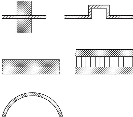
Abb. 12.5. Konstruktive Maßnahmen zur Erhöhung der Biegesteifigkeit
