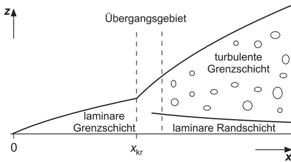
**Bild 1.4.** Schema des Übergangs von einer laminaren zu einer turbulenten Grenzschicht bei der parallel angeströmten ebenen Platte. Die in Richtung  $x$  angeströmte Platte beginnt bei  $x = 0$ . Die Stelle  $x_{kr}$  bezeichnet man als Umschlagspunkt. Unter der turbulenten Grenzschicht bleibt eine laminare Randschicht erhalten
