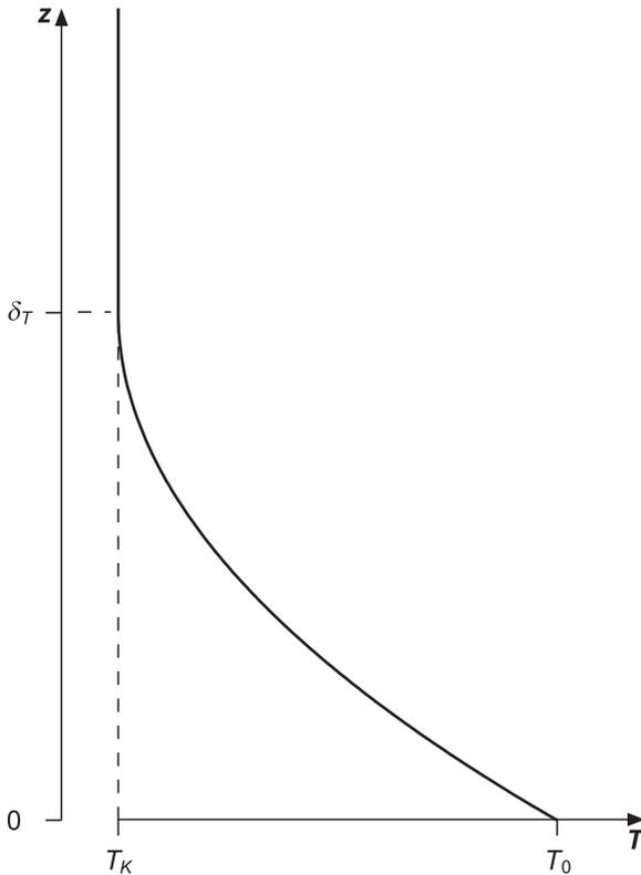
Bild 1.2. Schema einer Temperaturgrenzschicht mit  $T_0 > T_K$
