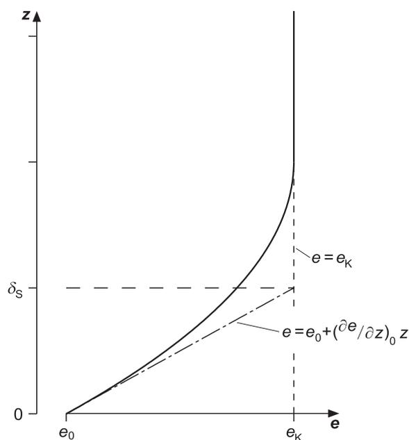
**Bild 1.6.** Zur Definition der Grenzschichthöhe aus dem Schnittpunkt der Geraden von (1.27)
