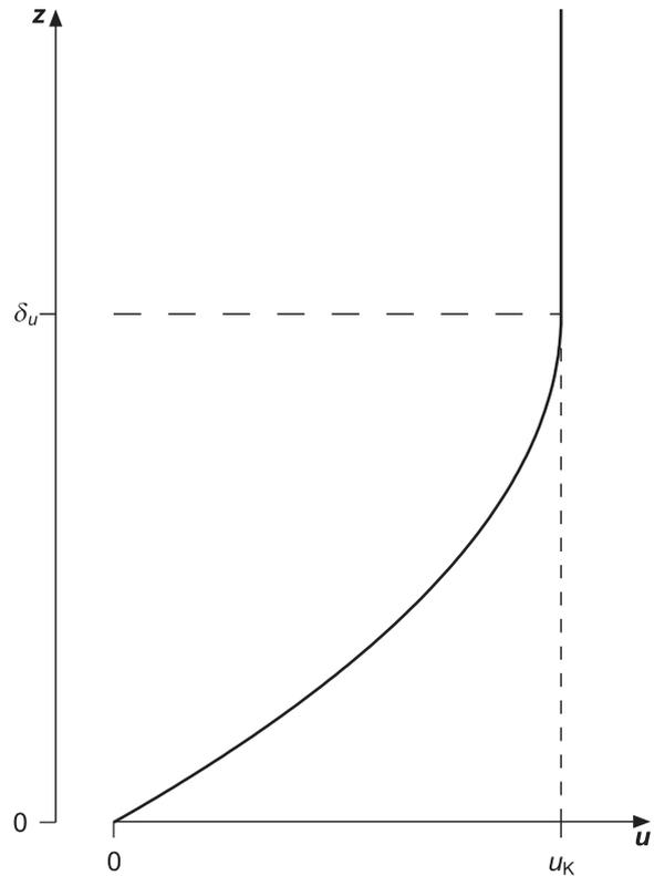
Bild 1.1. Schema einer Strömungsgrenzschicht
