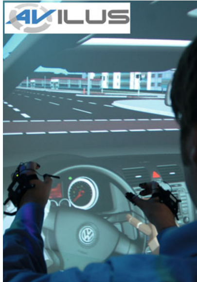
Abb. 4.5: Funktionale Absicherung eines virtuellen Fahrzeugs in einer CAVE
