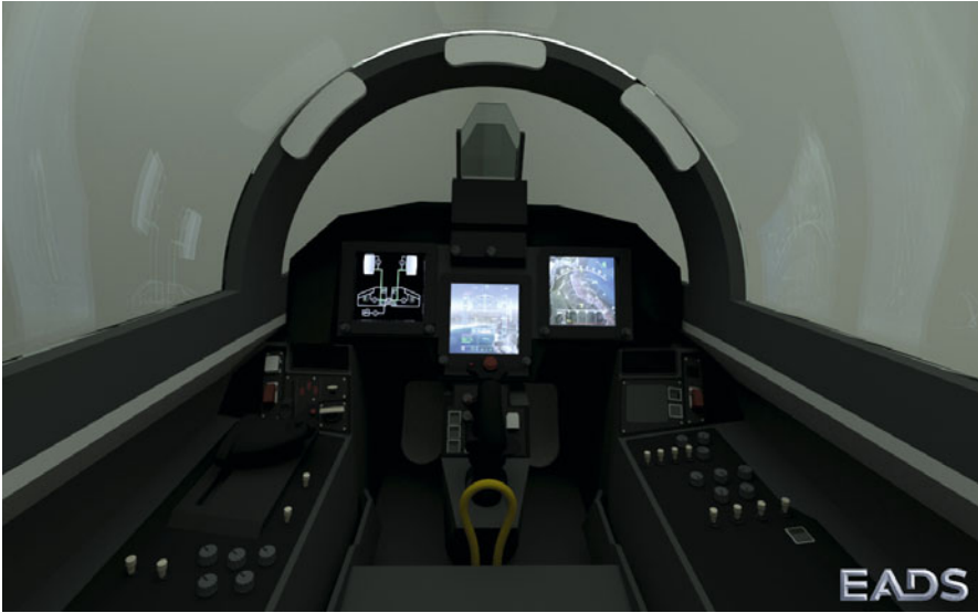
Abb. 4.2: Virtuelles Cockpit mit Displayreflektionen im Glas
