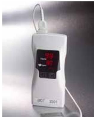
**Abb. 194 Pulsoxymetrie zur Messung der Sauerstoffsättigung [32]**
